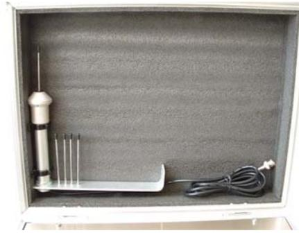
1/ Sortir l'antenne de ses deux pinces de maintien. Dévisser les 4 radars de leurs logements de rangement sur la patte support et les visser à la main dans les 4 trous à la base de l'antenne.
