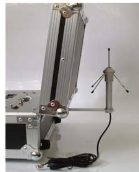
*Astuce : Pour améliorer la portée, le câble de l'antenne faisant 2.5m, vous pouvez très bien fixer l'antenne en hauteur (par exemple sur un piquet).*
