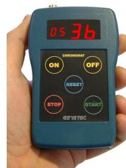
**Chronomaf** a spécialement été conçu pour la pyrotechnie. La luminosité de l'affichage est adaptée à une utilisation nocturne. L'affichage comporte deux tailles différentes, celui des secondes est plus grand car ce sont elles qui donnent les « tops » de départs : elles doivent être parfaitement identifiées d'un seul coup d'oeil. Pose de la pile : Ouvrez la trappe pile située au dos de l'appareil et installez une pile 9V PP3 alcaline. Refermez la trappe.
