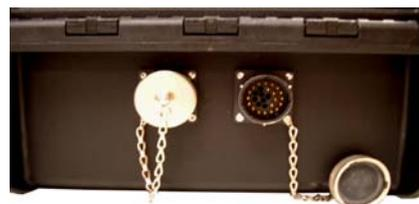
Le câble de liaison « multipaire » du BR100 doit toujours être déroulé à 100% pendant le tir. Pour verrouiller le câble « multipaire » sur les embases il faut tourner d'un quart de tour la bague métallique de la fiche (et non visser ou dévisser son capot noir).
