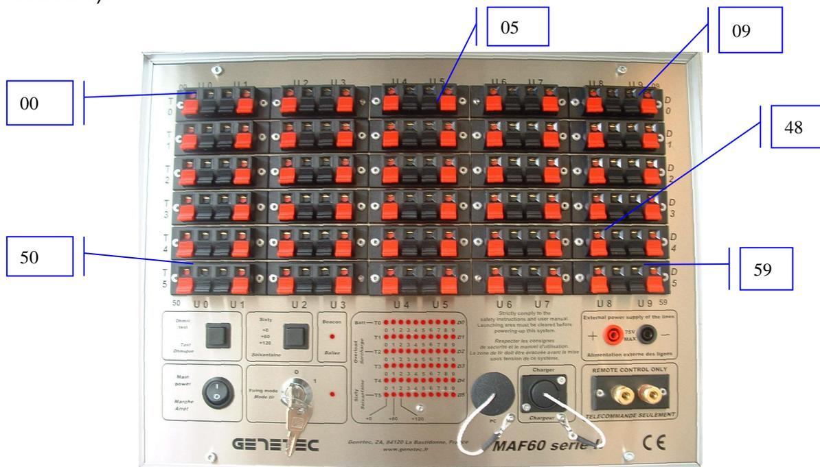
Il n'y a pas de commun sur les borniers de sorties. Donc, branchez une seule ligne par sortie (un fil sur le rouge et l'autre sur le noir). N'essayez pas d'adapter un câble multipolaire ou bien de relier ensemble des fils de lignes différentes.
