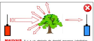
MAUVAIS II y a un obstacle de densité moyenne (végétation, foule...) entre l'émetteur et le récepteur. Le signal qui arrive est atténué à la fois par la distance et par l'obstacle.
